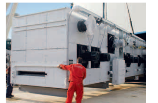
Die KBA Commander-Produktionslinie mit paralleler Anordnung der Trockner ermöglicht die flexible Hybrid-Produktion Coldset/Heatset
