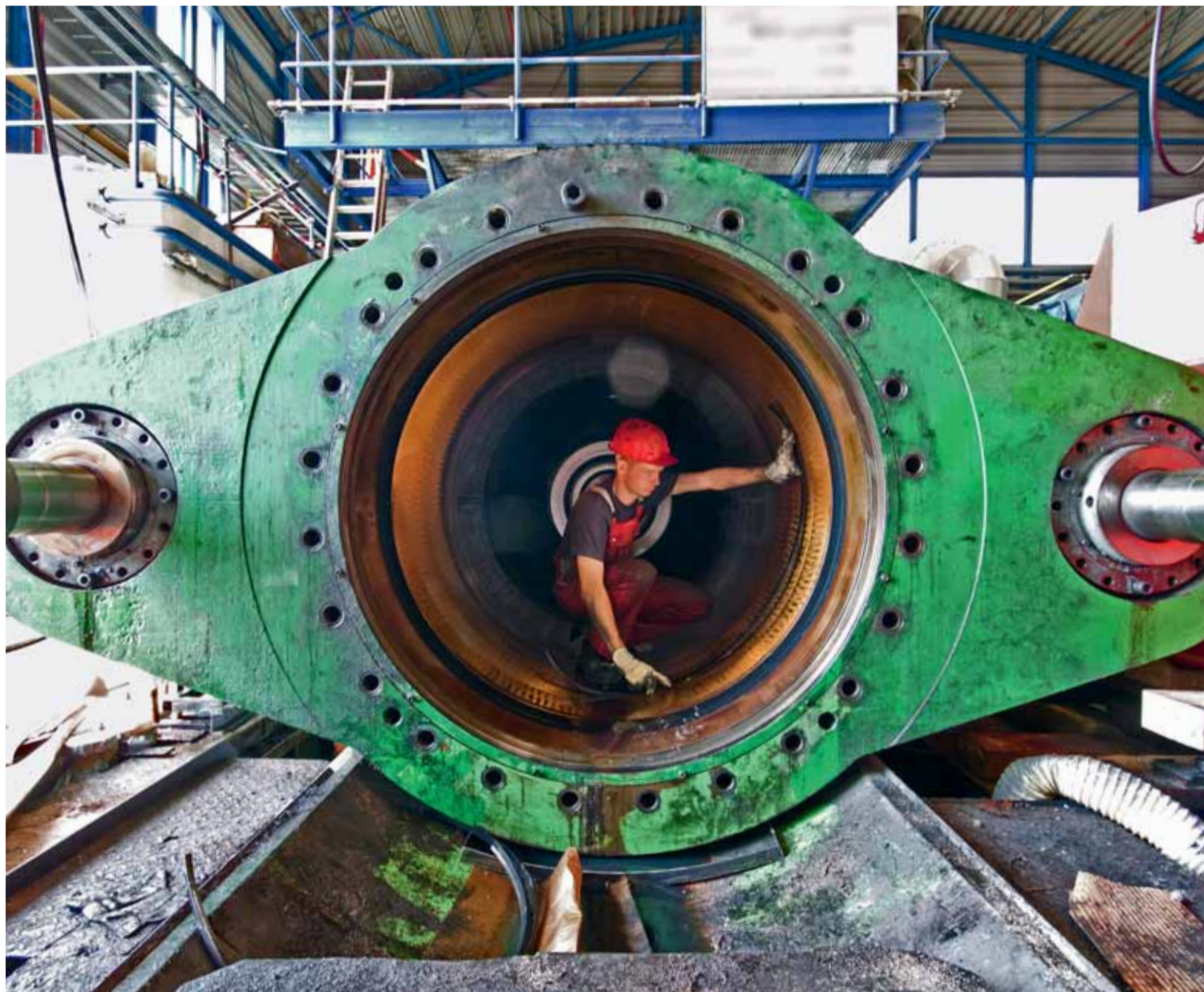
Der Zylinder der Aluminiumstrangpresse in der neuen Hauptschale
