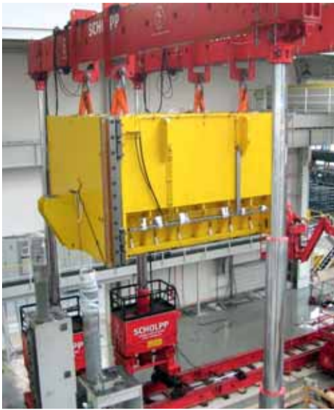
Nur noch zwei Zentimeter Platz sind zwischen dem Pressen-Stößel und den Zugankern
