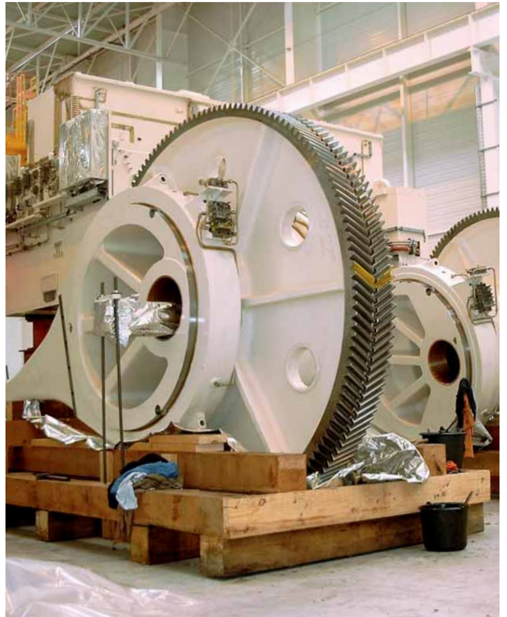
Kompletierter Radsatz fertig für den Einbau ins Kopfstück
