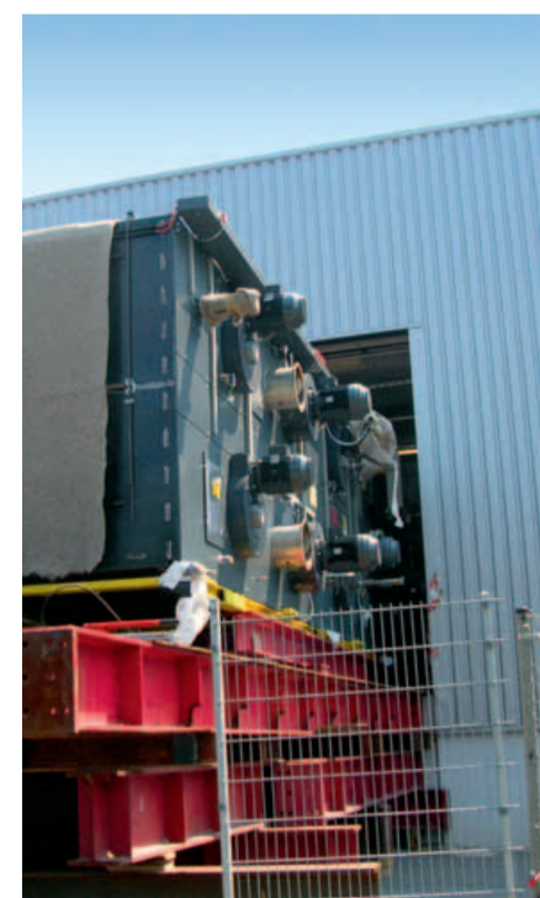
Enger Einstieg: Einbringung der Goss Sunday 4000 über die Außenrampen.
