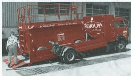
Scherenbühnen – meistens für den Innenbereich – erfordern spezielle Transportfahrzeuge
