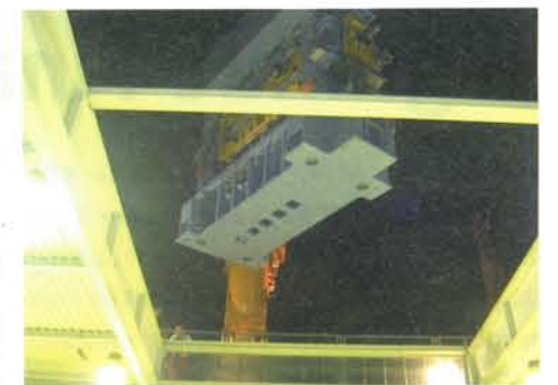
Nach der drei Stunden langen Reise vom Herstellerwerk in Heilbronn zu Layher nach Eibensbach wurde die etwa 120 to schwere Exzenterpresse mit Hilfe von zwei HK 650 und HK 160 Schwerlast-Autokränen von SCHOLPP Kran & Transport bei Scheinwerferlicht entladen.
