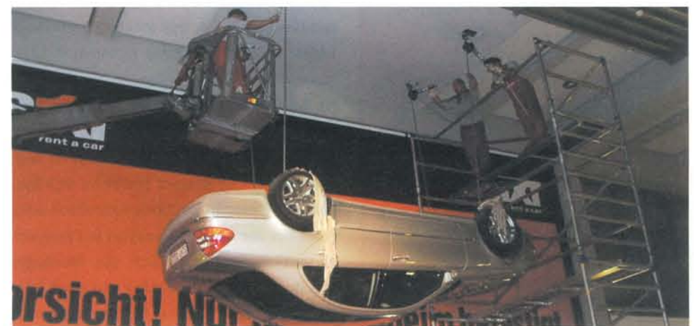
Mit 4 x 1,5 Tonnen Kettenzügen, mit je acht Meter langen Ketten, wurde das Fahrzeug zu Boden gelassen.
