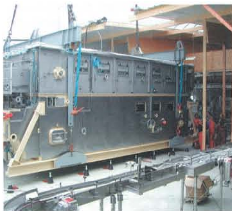
18 vorjustierte Stellfüße übertragen 60 to Gewicht auf die Decke!
