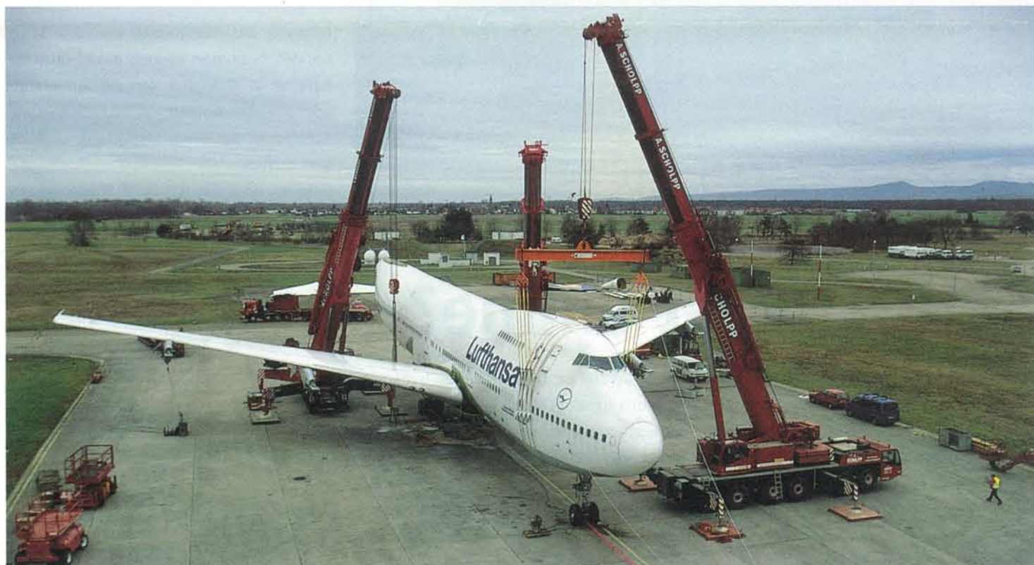
Hier heben 3 Scholpp-Krane, nämlich HK 650, HK 550 und HK 300, den Jumbo mit noch 130 Tonnen Gewicht an, um das Fahrwerk einfahren zu können.
