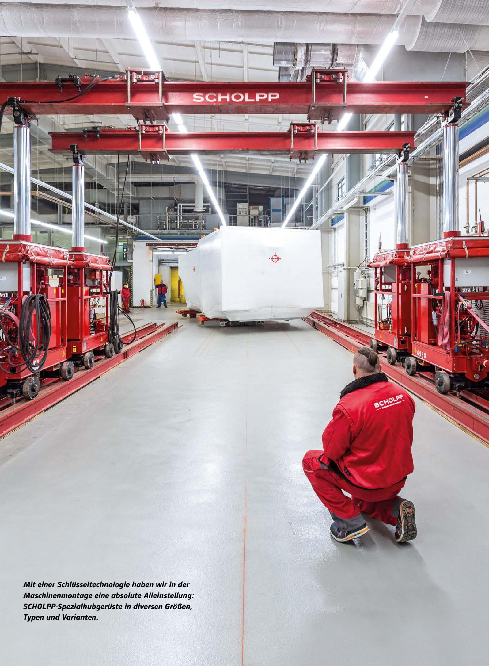
***Mit einer Schlüsseltechnologie haben wir in der Maschinenmontage eine absolute Alleinstellung: SCHOLPP-Spezialhubgerüste in diversen Größen, Typen und Varianten.***
