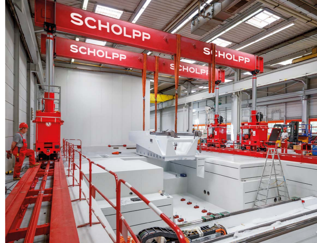
ELHA-MASCHINENBAU Liemke KG, Hövelhof: Einbringung einer Tiefbettfräse
