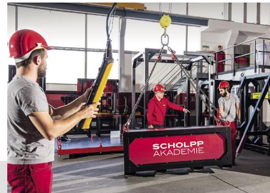
**Richtige Balance finden:** Bei Lasten mit ungleichen Schwerpunkten muss man wissen, wie die Kettenlängen angepasst werden.
